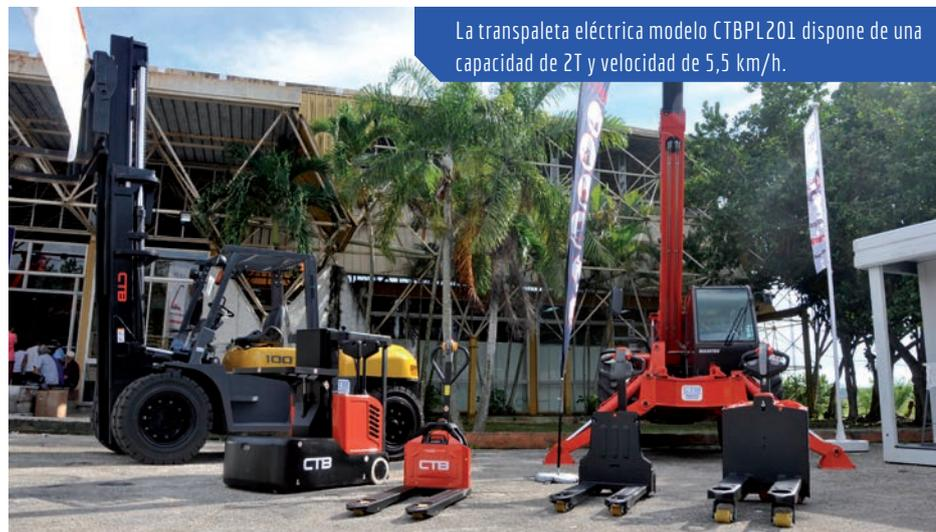
La transpaleta eléctrica modelo CTBPL201 dispone de una capacidad de 2T y velocidad de 5,5 km/h.
