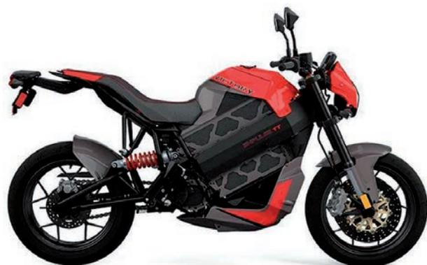
El pack de baterías es Brammo Power Lithium Ion con capacidad de 10,4 kW/h y un voltaje que varía entre 103,6 y 117,6 V máximo. Su autonomía es de 200 km en ciclo urbano, gracias al freno regenerativo. La batería está garantizada por el fabricante para 5 años u 80 000 km, con una capacidad mínima de 80 % de carga disponible.
